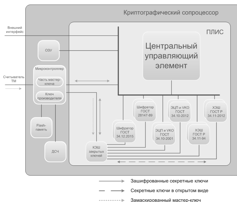
Рис. 1. Архитектура криптографического сопроцессора
