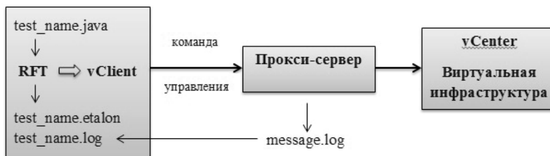
Рис. 1. Этап 1. Схема получения ожидаемого результата выполнения теста (test_name.etalon) и log-файла (test_name.log)
