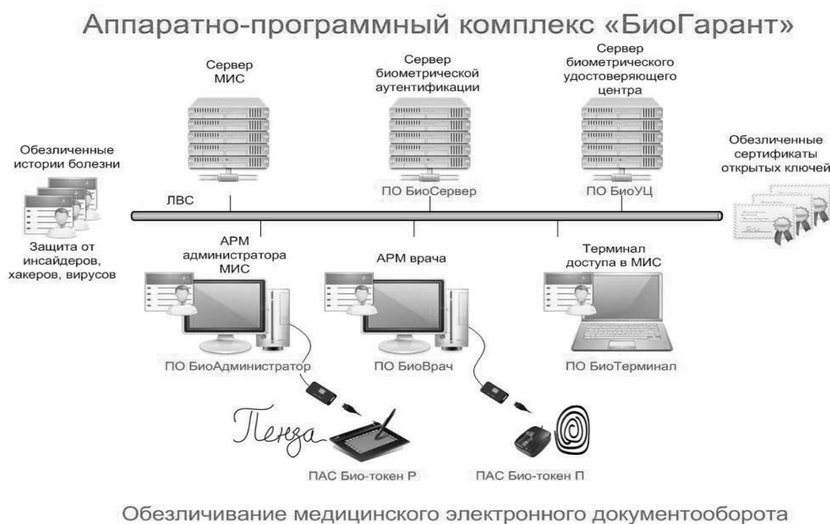
Рис. 7. Структура аппаратно-программного комплекса «БиоГарант», обеспечивающего биометрическое обезличивание МИС
