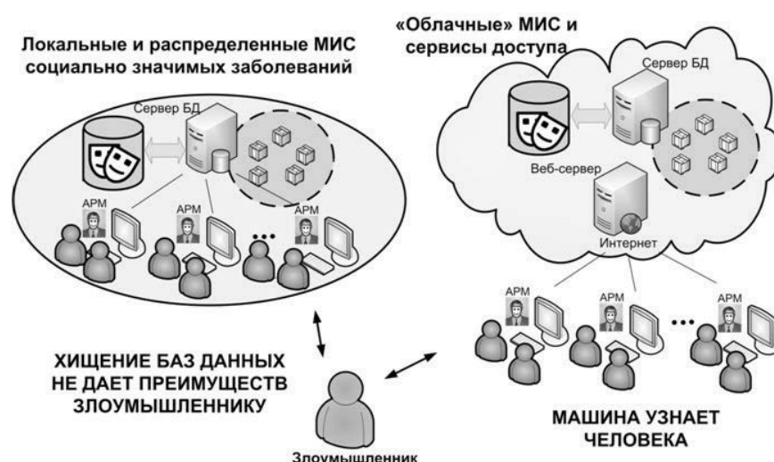
Рис. 1. Защита персональных данных в медицинских информационных системах через обезличивание с биометрической аутентификацией пользователей
