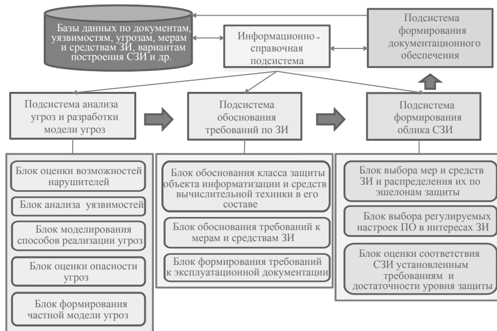
Рис. 1. Обобщенная структура СППР в области ЗИ
